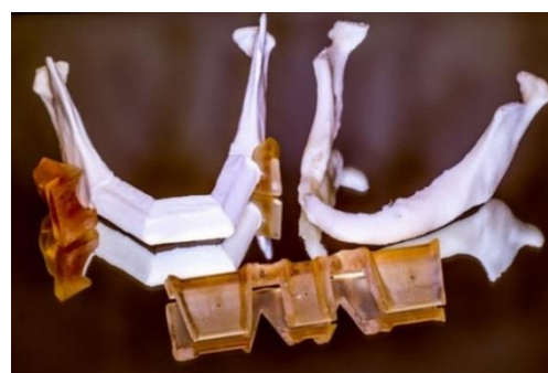
Figur 11. Modeller och guider. Postoperativ modell (t.v.) och patientens underkäke i anatomisk fixerad position (t.h.). Såg och resektionsguider tillverkades i Formlabs Dental material.
